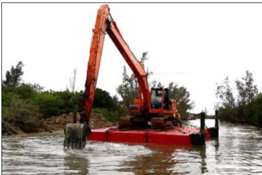
Figura 2-1 – Equipamento para remoção de material vegetal e detritos.
