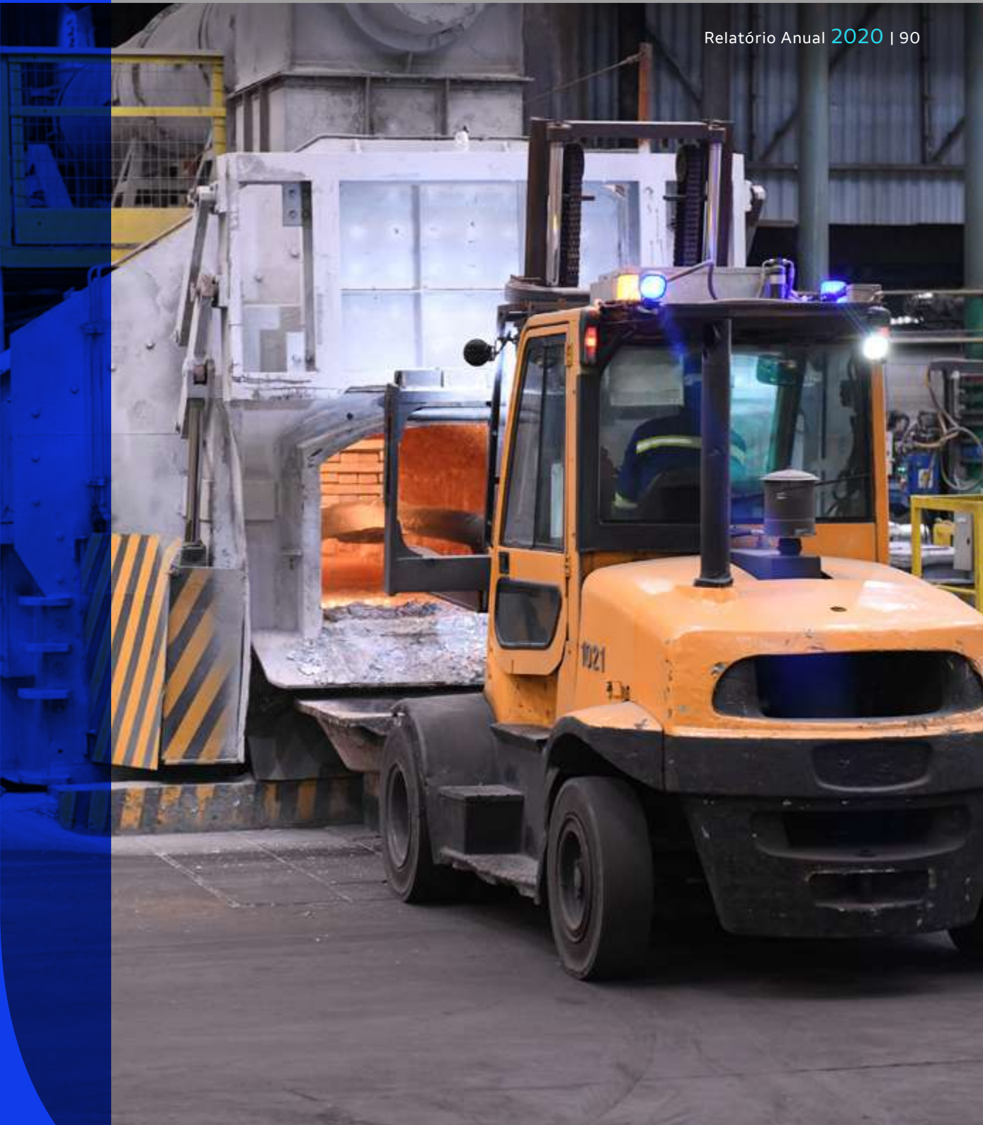
Carregamento de fornos na área da Fundição
