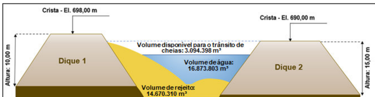
Figura 11-5 – Croqui esquemático dos Diques.
