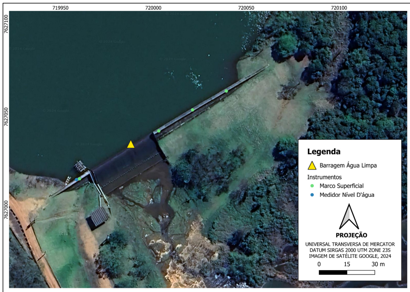
Figura 15.1 – Sistema de Monitoramento da Barragem Água Limpa.
