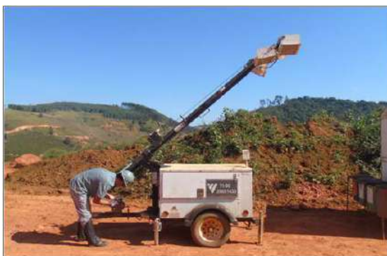
Foto 2.4.1-19 - Modelo de torre de iluminação utilizado na frente de lavra
