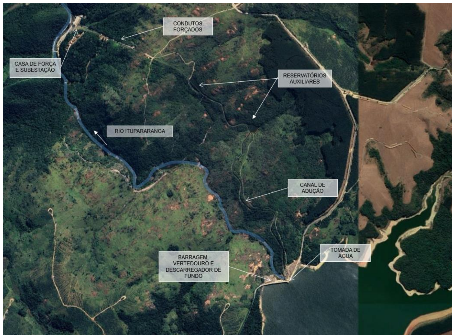
Figura 1. UHE Itupararanga – Arranjo Geral - Planta.
