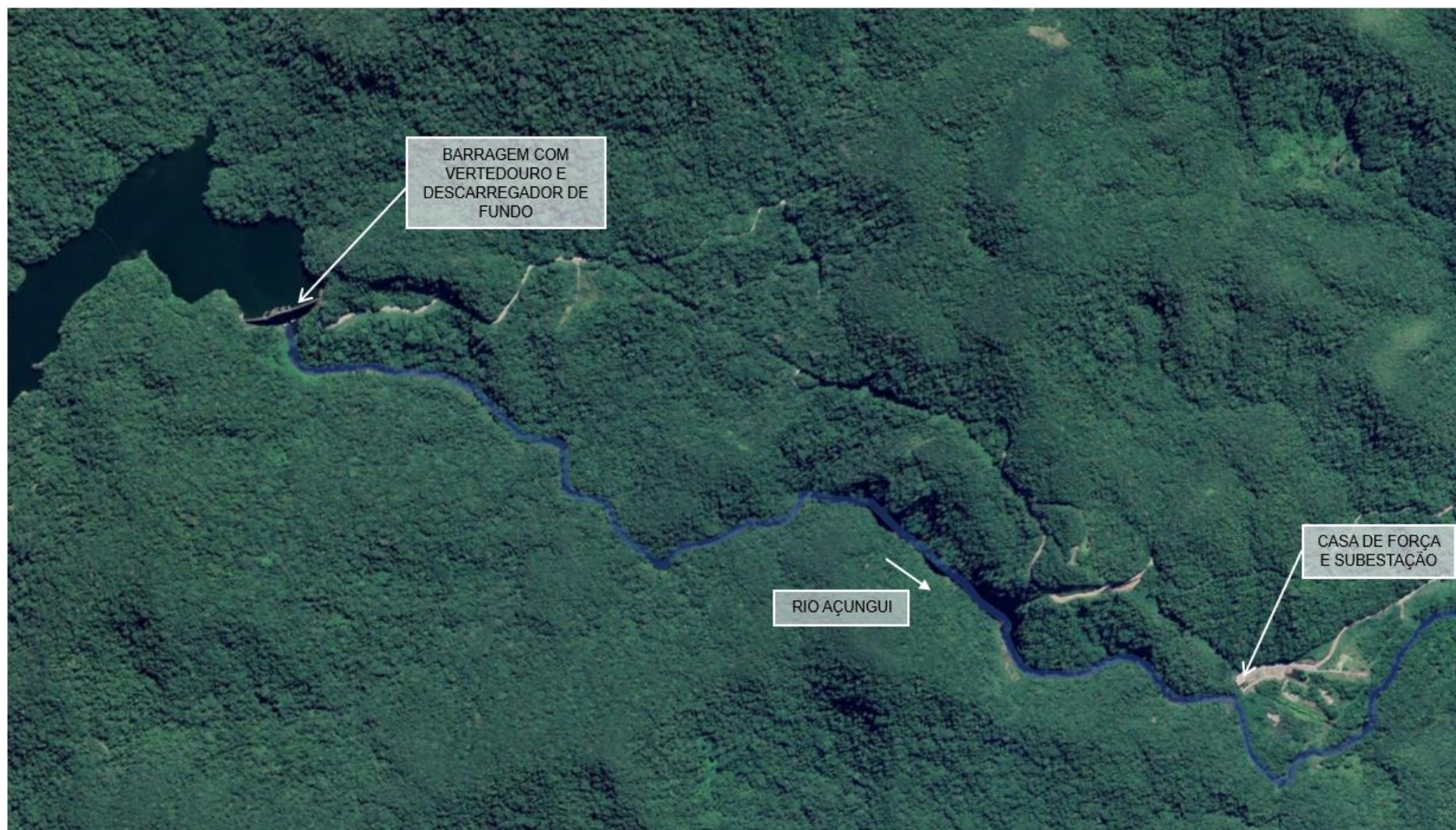
Figura 1. UHE Salto do Iporanga – Arranjo Geral - Planta.
