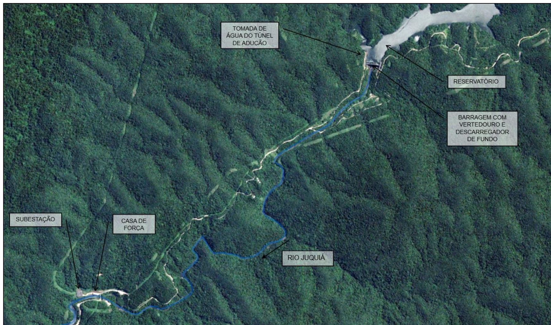
Figura 1. UHE Alecrim – Arranjo Geral - Planta.
